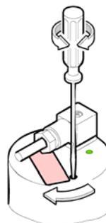
使用 1.5 毫米螺丝刀, 调整 <ATM> 电位器 ...
