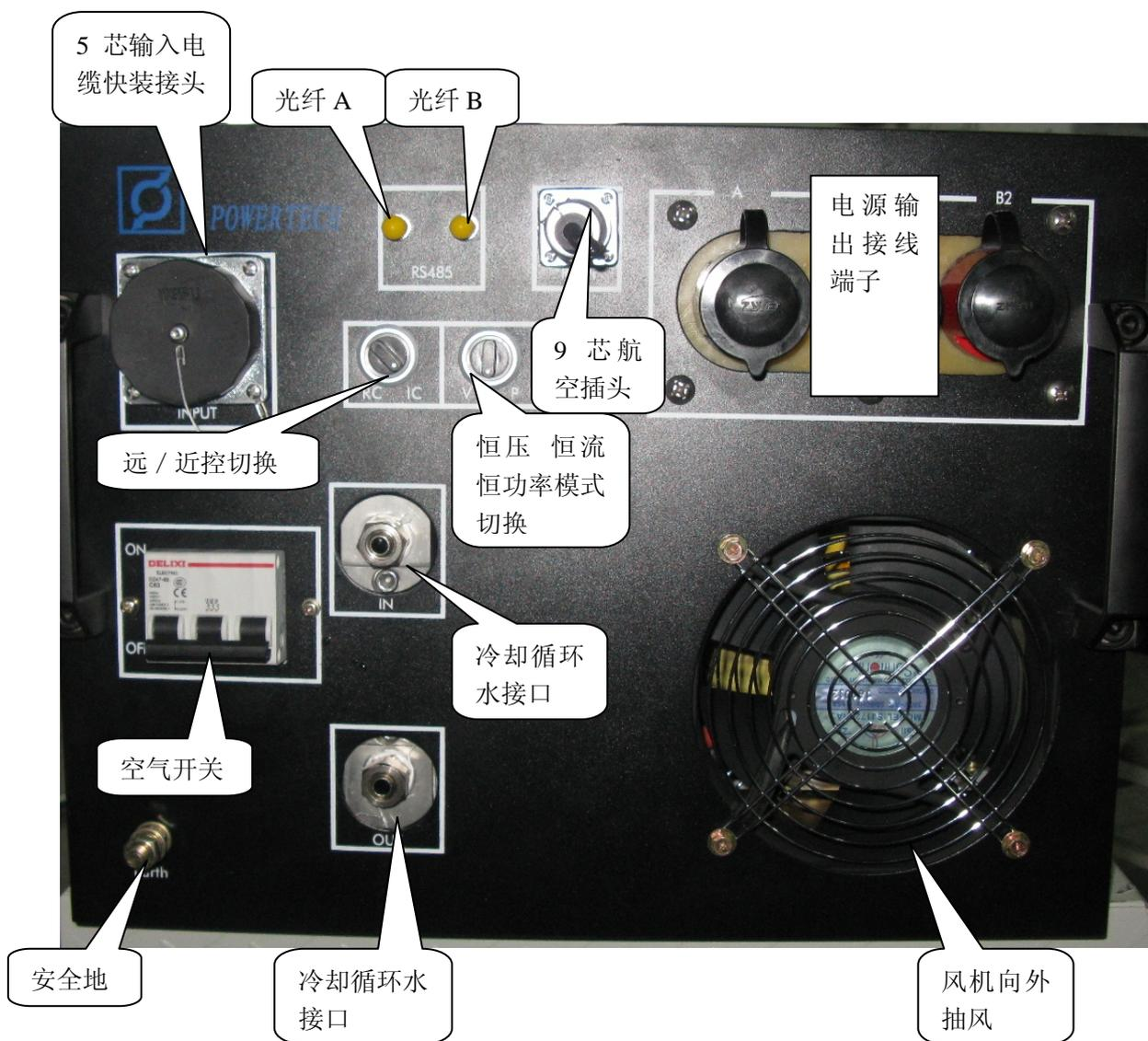
电源后面板示意图（图二）
